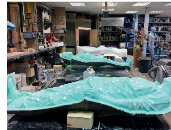
Fluxaxis'deki Massivit 1800 3D yazıcıda üç boyutlu basılmış iki gerçek boyutlu esas figür.
