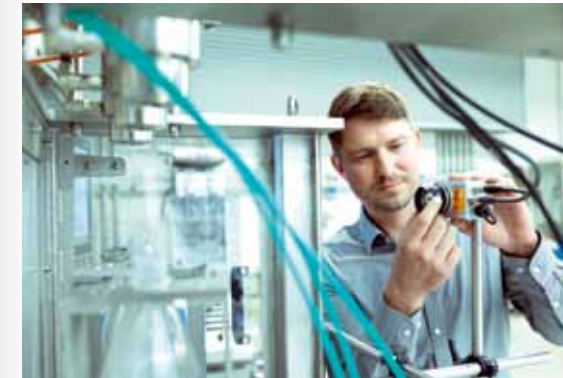
Bir kamera, şişeleme işlemi sırasında kabarcıkların ve köpüğün etkisini kontrol ederek ürün kayıplarını önlemeye yardımcı olur (Foto: KHS GmbH)
