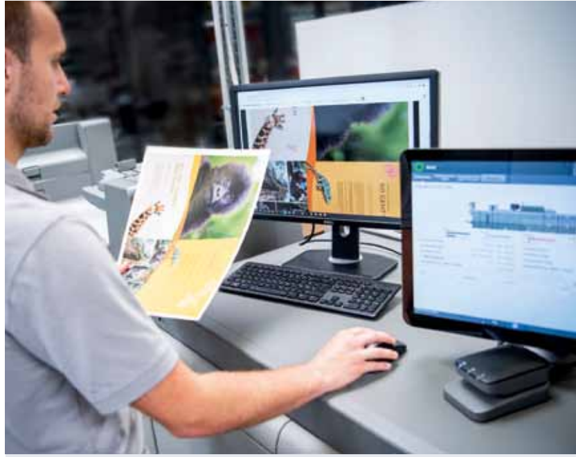
Heidelberg'den Versafire EP'DE yeni bir satır içi Kalite Güvence Sistemi mürekkep beslemesini kontrol eder ve baskı görüntüsündeki hataları algılar.
