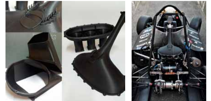
CF-PA-12 filament ile basılmış manifold ve manifoldun takılı olduğu bir PMT-12 yarış arabası.
