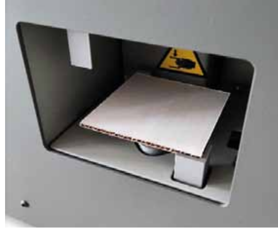
SST - Kesim Sertliği Testi (SST): test soketi
