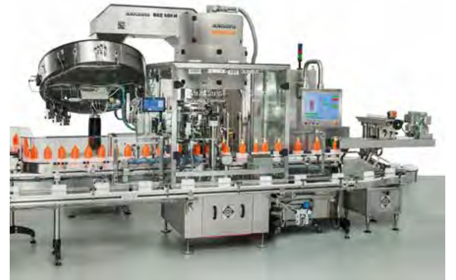
Robomat dolum hattı, doldurulmuş kozmetik şişelerine otomatik olarak çok farklı kapaklar takıyor (Görsel: Rationator)
