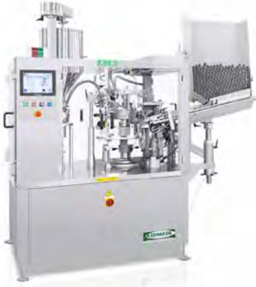
Otomatik olarak yeni bir tüp dolum makinesi plastik, lamine ve alüminyum tüpleri dolduruyor ve kapatıyor (Görsel: Marchesini Group)
