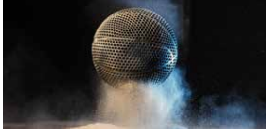
3D baskılı Wilson Airless Prototipi son işlem ve bitirme adımlarından önce (Kaynak ve ©: Wilson Sporting Goods Co.)
