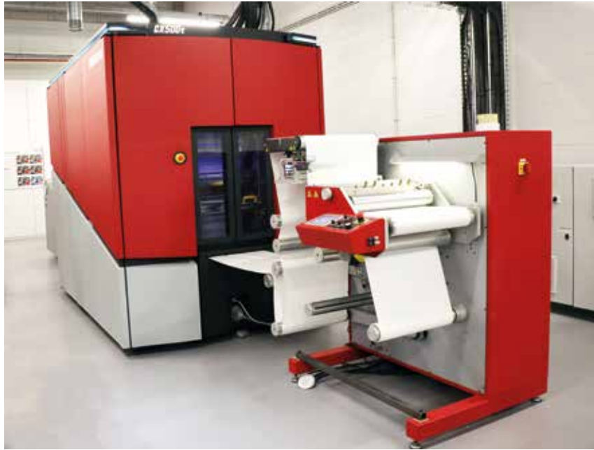
Xikon CX500t, TITON tonerini çapraz bağlamak için bir LED kürleme ünitesine sahip (Kaynak: pack.consult)
