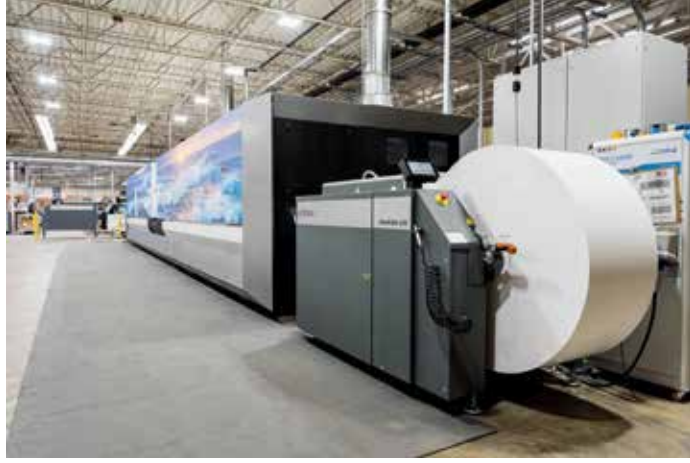
Canon ProStream 1800'e uygun olarak Tecnau Revolution 50 Rulodan Rulo, Unwinder u50 ve Rewinder r50
