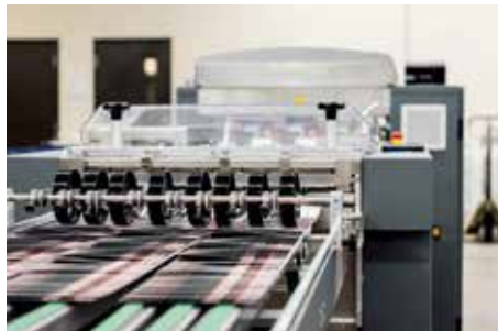
Tecnau CutReady çözüm çıkış konveyörünün detayı
