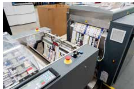
Tecnau CutReady çözümünün detayı çözücünden çıkan ve kesici modülüne giren gevşek ağ
