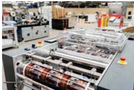
Tecnau CutReady çözüm giyotin kesici modülünün detayı
