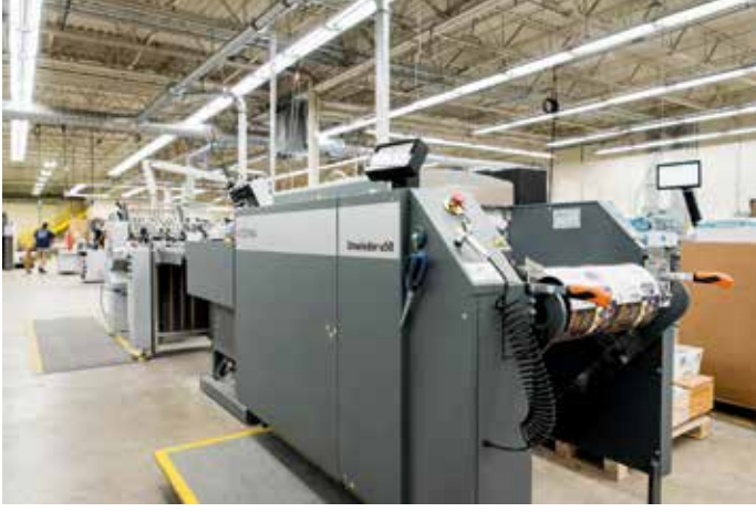
Tecnau CutReady hat besleme Heidelberg Stahlfolder TH 66
