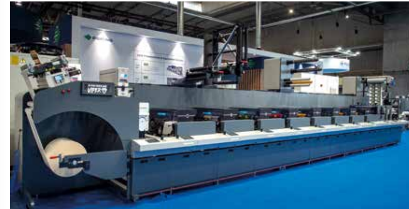
SCREEN ve Lombardi Converting Machinery tarafından, Lombardi'nin Digistar Hybrid serisiyle derinlemesine entegre edilmiş SCREEN Truepress LABEL SAI S mürekkep püskürtmeli etiket baskı makinesi etrafında yapılandırılmış güçlü bir hibrit etiket baskı çözümü
