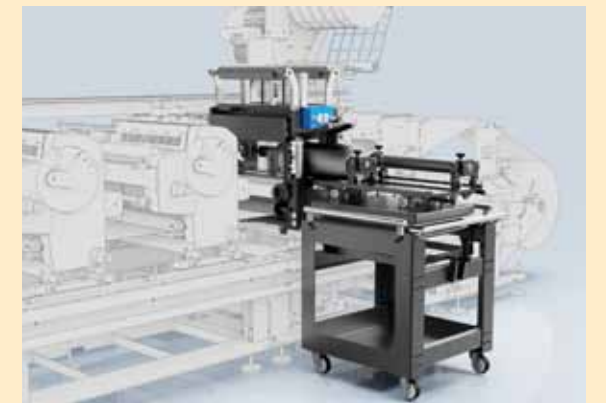
Rotary Die-Cut Unit Quick (RDC Quick), üniteli Gallus Labelmaster üzerinde şekilli kesimde iş değişikliği bir dakikadan az sürüyor.
