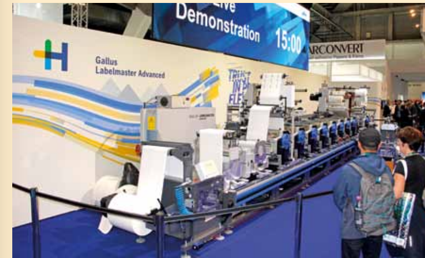
Rotary Die-Cut Unit Quick (RDC Quick), üniteli Gallus Labelmaster üzerinde şekilli kesimde iş değişikliği bir dakikadan az sürüyor.
